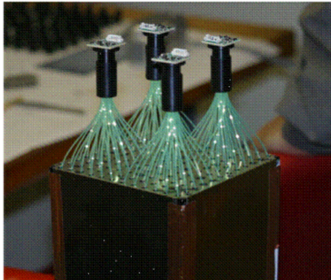
Abbildung 8: Aufbau der im EMCal aufgebauten Lichtleiter und Photomultiplier[21].
